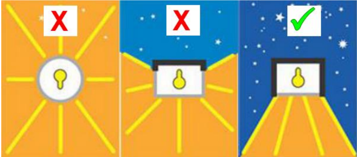
Abbildung 15: Schematische Darstellung der Ausleuchtung in Abhängigkeit von der verwendeten Abschirmung des Leuchtmittels. Links: Ohne Abschirmung, Mitte: Unzureichende Abschirmung, Rechts: Ideale Abschirmung mit nur nach unten gerichtetem Lichtkegel.
