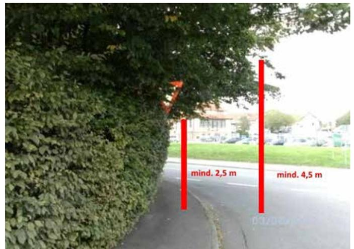
Bitte beachten Sie eine lichte Höhe von 2,5 m über dem Gehweg und 4,5 m Höhe über der Fahrbahn. Bei Bedarf müssen auch Verkehrsschilder freigeschnitten werden.
